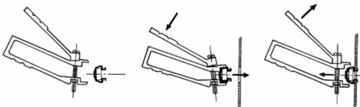
Diese Zange ermöglicht ein schnelles und genaues Einsetzen der Käfigmuttern in Stanzlöcher 8,3 x 8,3 und 9,5 x 9,5 mm.
